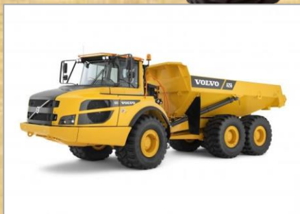
車種：A25GTS 積載量：25,000kg 積載容量：15.3 \text{m}^3 年式：2023年、2024年
